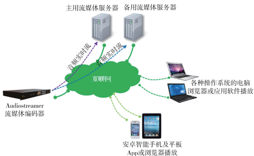
图 1 互联网广播系统应用示意图
