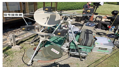
拍摄地点中的无线摄像系统 信号接收器(图中的抛物面天线并不是接收 8K 信号的天线)
