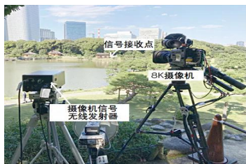
拍摄地点中的无线摄像系统 信号接收器(图中的抛物面天线并不是接收 8K 信号的天线)
