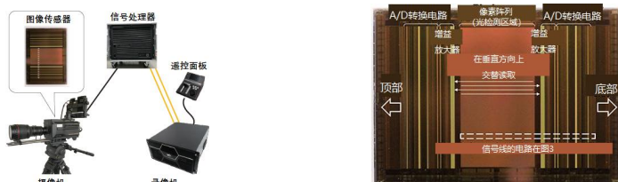
图 1: 8K 240 帧/秒拍摄和录制系统 图 2: 图像传感器芯片（旋转 90°）
