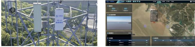
然而，通感一体在低空领域应用中，存在网络信号覆盖难、感知精度误差大等挑战。为此，中国移动创新提出“双层移相超级张角新硬件”，引领产业由传统的 24° 垂直张角扩展至 60° 以上，在拉齐对地覆盖能力的同时，将通信及感知能力扩展至 300 米低空，为建立地空立体网络奠定硬件基础。在感知管理方面，基于 5G-A 与 6G 协同推进多业务融合的设计理念，打造“Master+Slave 两级 BBU 新架构”，实现集中式关联、融合轨迹去重和联合结果上报等感知目标管理方案，实现低空领域等广域范围内的高精度高确定性感知。
